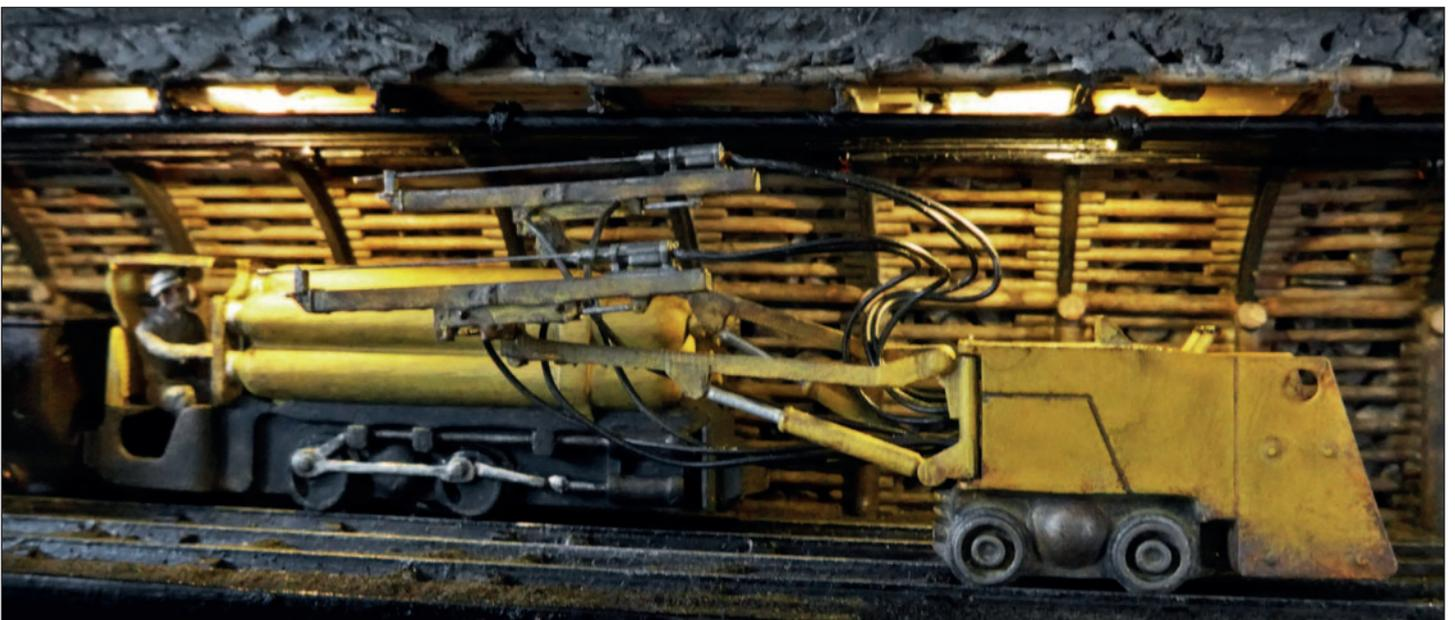
Der Gleisbohrwagen SBKNS 2 im Hintergrund die Pressluftlokomotive.
