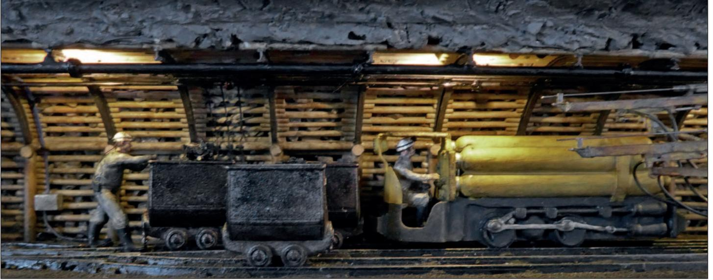
Der Hauer schiebt den vollen Hunt zur Pressluftlokomotive BVD 35.
